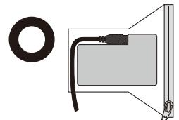
バッテリーと配線の向きに注意して、配線が捻じれないようにポケットに収納します。
