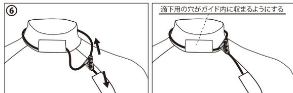
エンドキャップをスライドさせてチューブの輪を調整し首に密着させる
