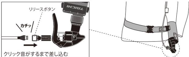
❗ 送水チューブが折れ曲がっていないか確認してください。曲がっていると送水できずチューブが外れる、またはポンプが破損する場合があります。
