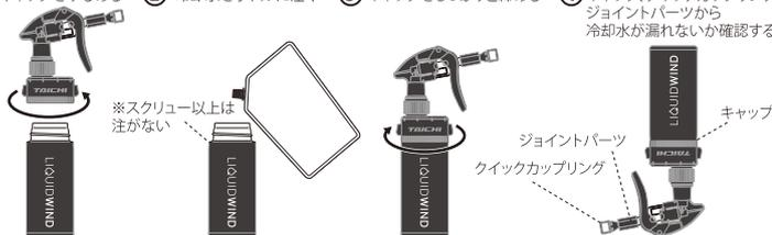
⚠️ ジョイントパーツはしっかりと締め付けられた状態で使用します。ジョイントパーツが締め付けられていないと内部のパッキンから冷却水が漏れる可能性があります。ゆるい場合は手で締め直してください。
