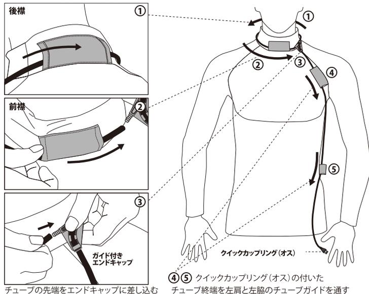
④⑤ クイックカップリング(オス)の付いたチューブの先端をエンドキャップに差し込む
